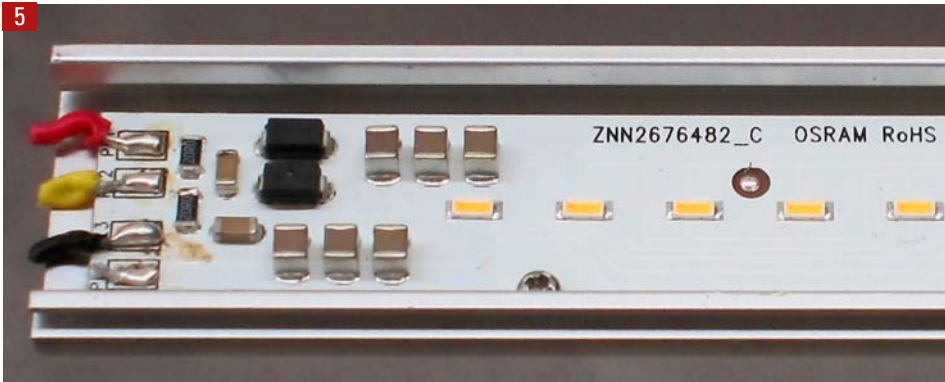
Ausschnitt aus einer modernen LED-Röhre mit SMD-LED ohne Abdeckung.
