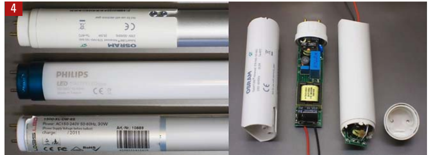
Links drei Messmuster fürs Lichtlabor, rechts das Innenleben einer LED-Röhre.
