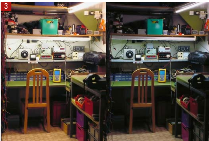
Links konventionelle Leuchtstofflampe, rechts LED-Röhren mit 50 % elektrischer Leistung aber auch nur 50 % Licht.
